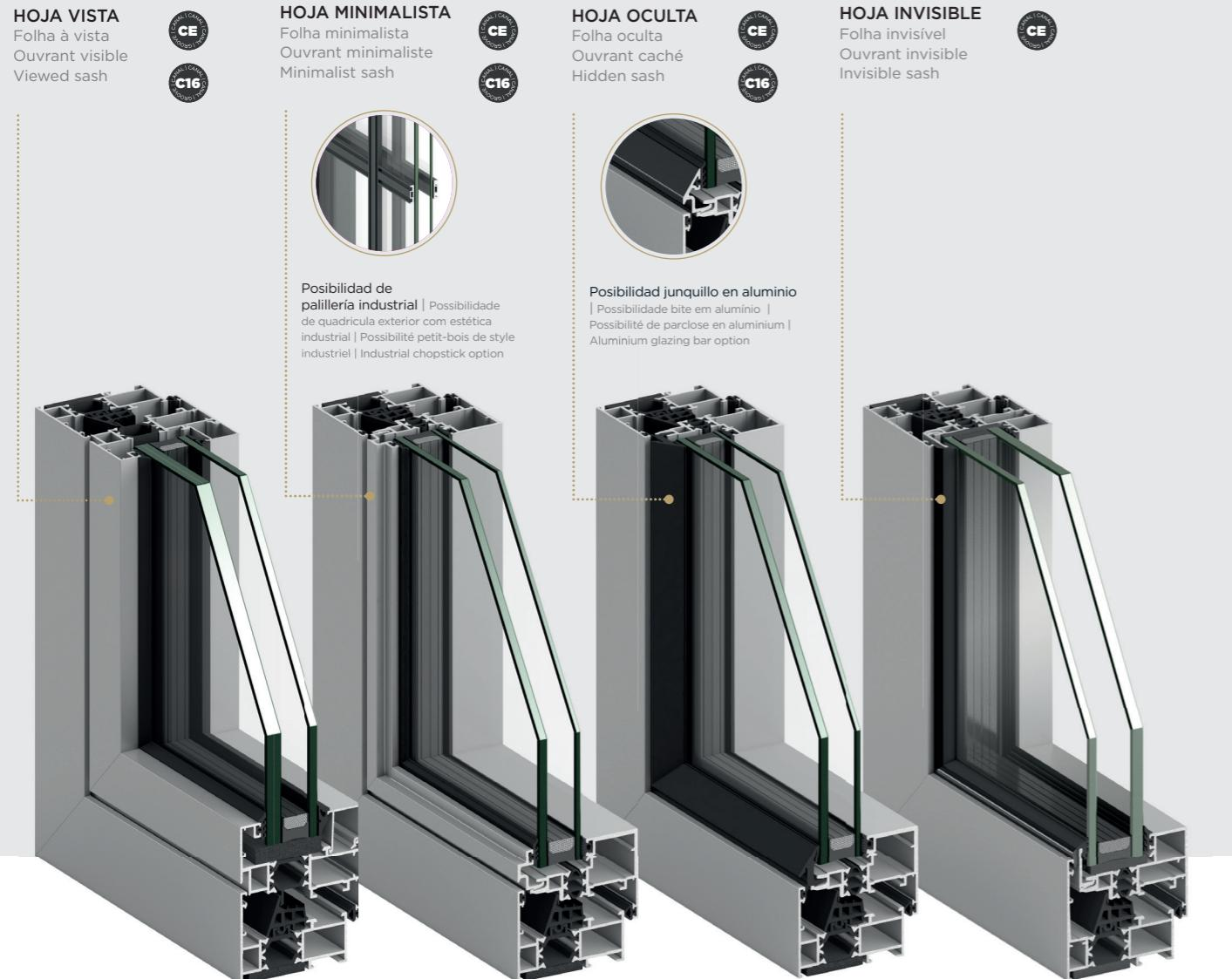
Líneas rectas, coplanar al exterior y aislamiento reforzado mediante poliamidas y espumas de poliolefina opcionales. Con posibilidad de hoja vista, oculta, minimalista invisible y variantes en canal europeo y canal 16.
